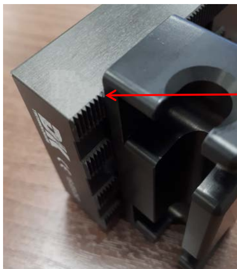
37 pav. Šablono tinklelio laikiklis ties 8-ojo krumpio padėtimi
