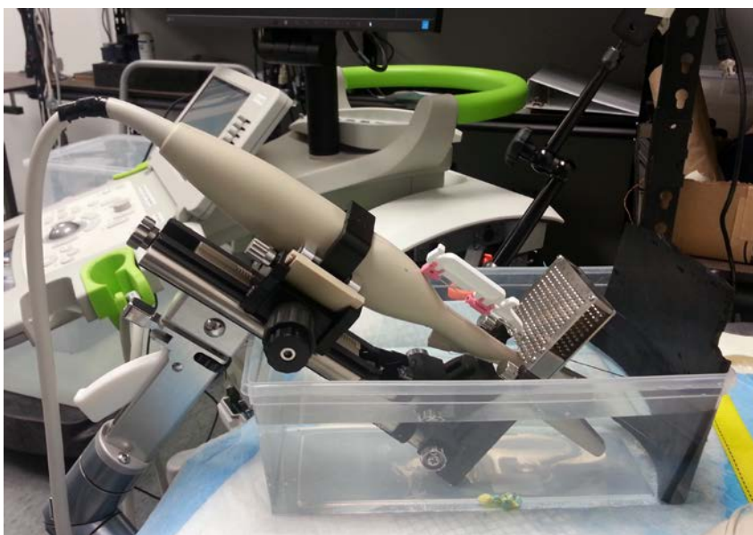
41 pav. Keitiklis ir transperinealinis žingsninis įtaisas vandens vonelėje
