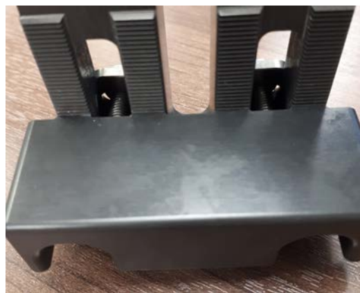
38 pav. Centruotas šablono tinklelio laikiklis
