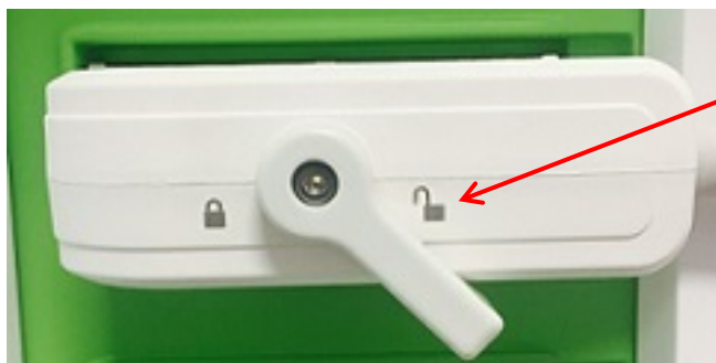
29 pav. Atrakinta keitiklio jungties užrakto rankenėlė
